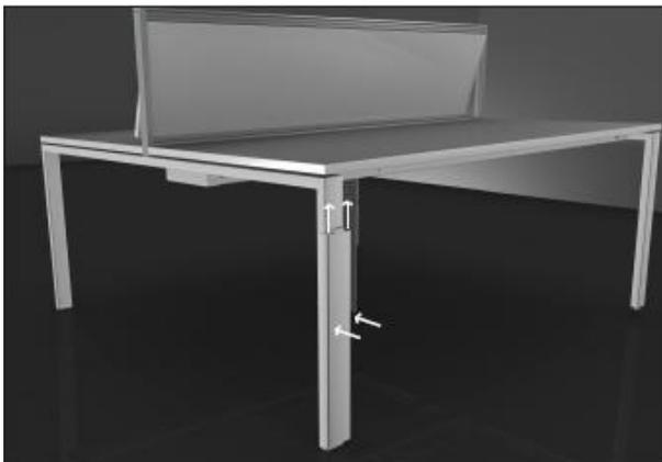
Passe-câbles vertical disponible, qui permet le câblage vertical le long des pattes, fabriqué en tôle d'acier laminé d'1,5 mm et peint par application de poudre époxy finition texturé au four en aluminium, blanc et graphite, avec une couche d'épaisseur moyenne de 60 microns. Possibilité de mettre 2 unités face à face sur un même pied. Ses dimensions sont de : 8 mm x 55,8 mm x 3 mm.
